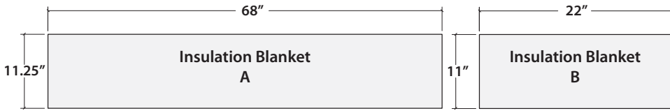
Mini Ceiling Mount blanket dimensions
